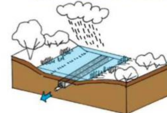
Noue drainante en terrain peu perméable avec massif drainant (enrochement + drain d'évacuation)
