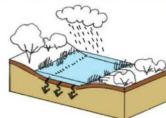
Noue d'infiltration naturelle en terrain perméable
