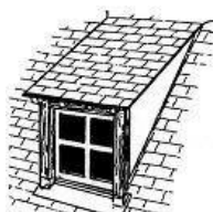
lucarne rampante ou en chien couché
