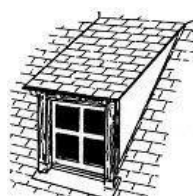
lucarne rampante ou en chien couché
